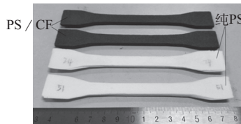
图8 PS/CF与纯PS烧结件对比图
